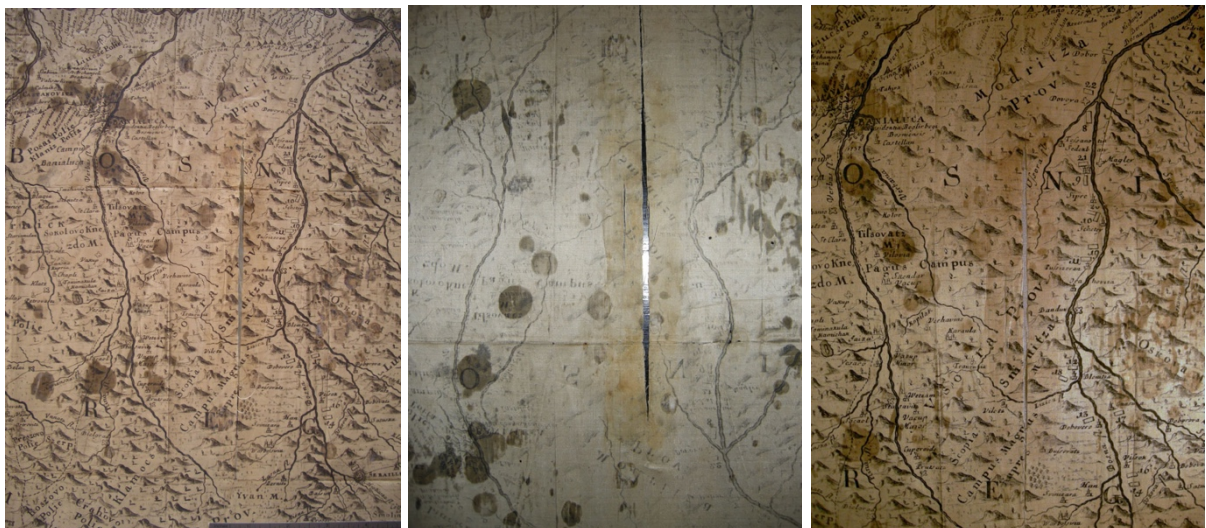
Vorderseite, Riss in der Mitte, vor (l.) und nach der Restaurierung (r.), Rückseite nach Abnehmen der Reparaturstreifen und Klebereste (m.)
